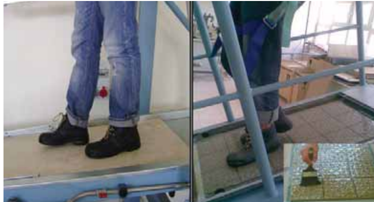
Şekil 2. DIN 51130 standardına göre test ve kalibrasyon İşlemi (SAM)
