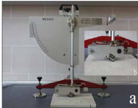
Şekil 3. Pandül test cihazı (wessex)
