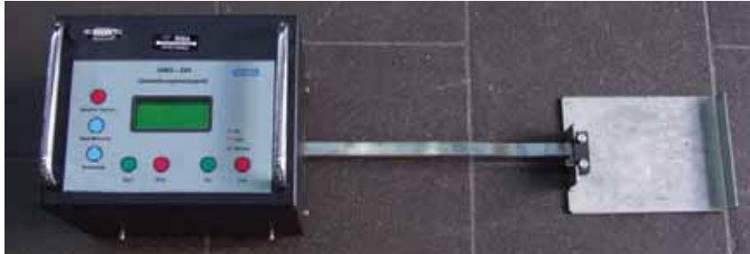
Şekil 4. GMG 200 taşınabilir (mobil) sürtünme katsayısı ölçüm test cihazı
